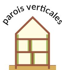
En soufflage dans ossature bois, isolation intérieure, extérieure ou cloison (50kg/m<sup>3</sup>).
